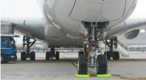
Câbles polyvalents, très souples, résistants à l'abrasion, au skydrol, au kérosène et autres produits destinés à alimenter les avions au sol.
