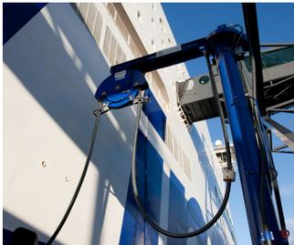
Câbles pour alimentation des navires à quai et de recharge pour bateaux électriques.
